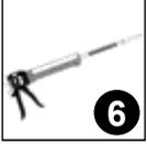
Solo después de que el cartucho se haya balanceado, colocar la boquilla de mezcla adecuada de Adhesives Technology en el cartucho (ver Tabla 1). No modificar la boquilla de mezcla. Confirmar que el elemento mezclador interno esté en su lugar antes de suministrar el adhesivo. Tomar nota de las temperaturas del aire y del material base y revisar la tabla de tiempo de trabajo/curado completo (ver Tabla 4) antes de iniciar el proceso de inyección.
